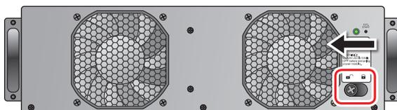
Рис. 7-7. Разблокировка защёлки
