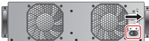
Рис. 7-6. Блокировка защёлки
