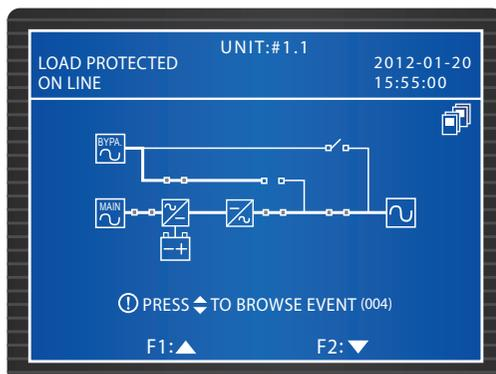
В. Если суммарная мощность нагрузок больше суммарной мощности оставшихся параллельных ИБП, то на всех параллельных ИБП отключатся инверторы и все параллельные ИБП перейдут в режим байпаса. Мощность всех нагрузок будет равномерно распределена между всеми параллельными ИБП. На всех ИБП появится следующий экран.
