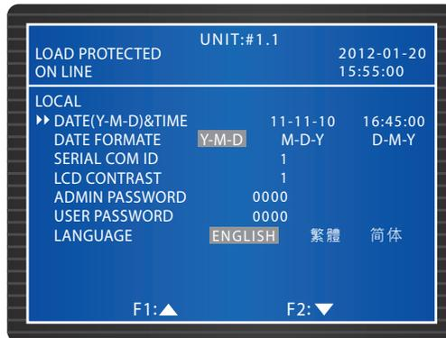
На этом экране можно задать внутренние настройки. Если ИБП соединены параллельно, то для каждого ИБП можно задать **ID ПОСЛЕД. ПОРТА**.
