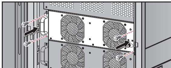
Рис. 7-5. Фиксация винтами
