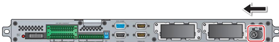
Рис. 7-15. Разблокировка защёлки
