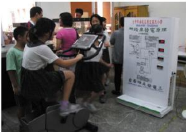
台中市惠文国小惠文国小所设计的脚踏车发电机组可启动风扇
