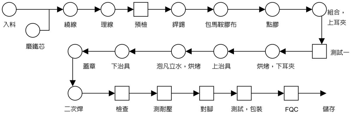
視訊產品製造流程—顯示器
