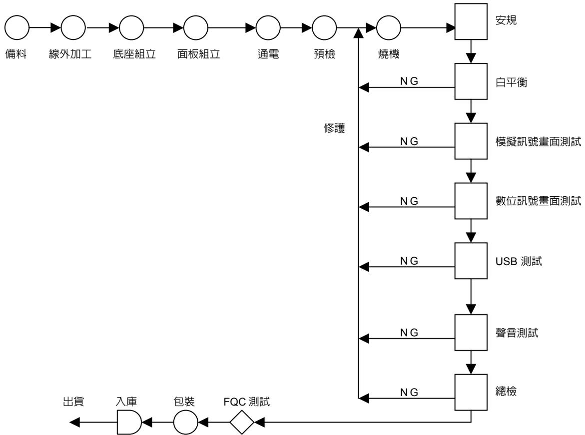
機電產品製造流程—變頻器
