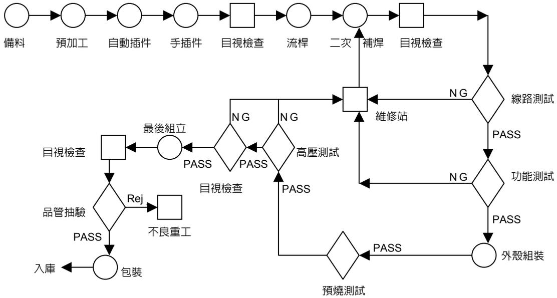
零組件產品製造流程—電磁零件
