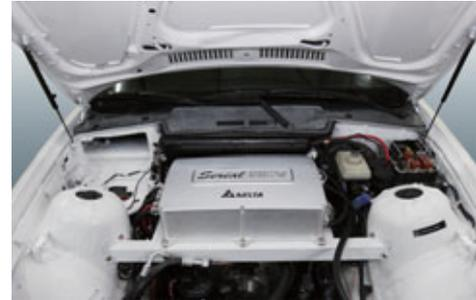
複合動力及電動車用動力控制器
