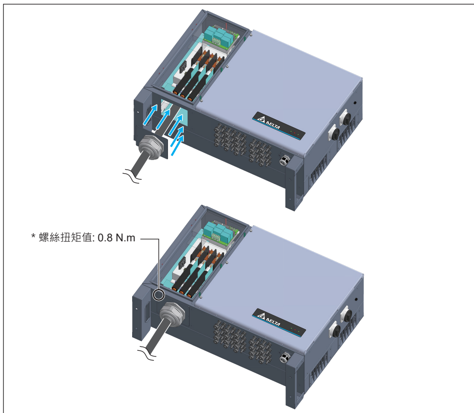
圖 3-18: 交流電纜安裝
