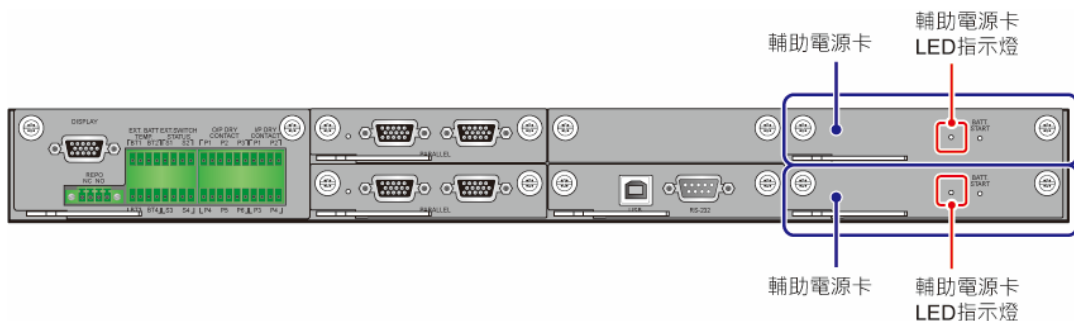
(圖 4-18 : 輔助電源卡 & 輔助電源卡 LED 指示燈位置)
