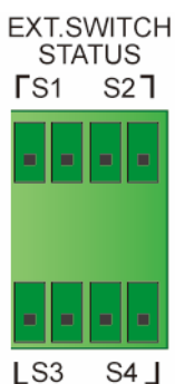
(圖 4-11：外接開關/ 斷路器狀態偵測乾接點 (EXT. SWITCH STATUS) 腳位圖)
