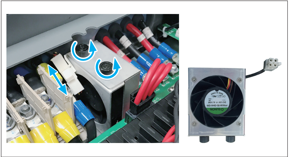
圖5-13：拆卸配線箱區塊之智慧風扇 (僅M88H_122)
