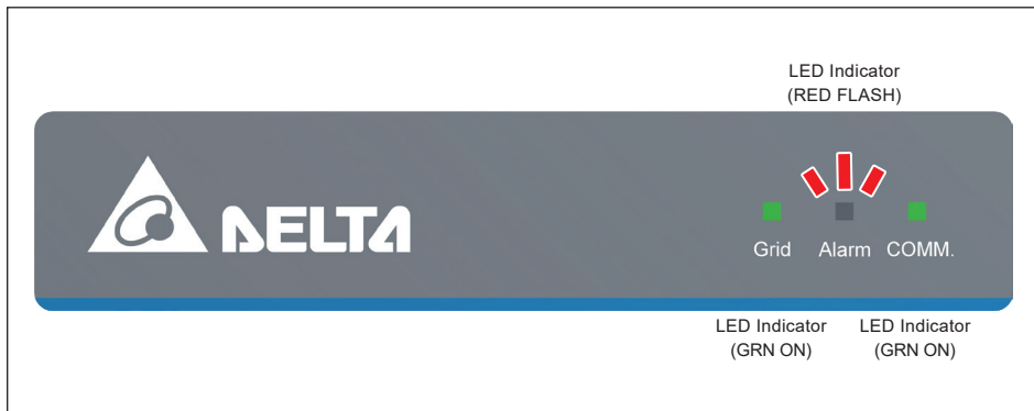
圖 5-5 : SPD故障時的面板顯示
