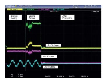
Die Wechselrichter von Delta haben eine integrierte Schutzfunktion zur Erkennung von Lichtbögen auf der Gleichstromseite, vor allem an den Steckverbindern und in den DC-Kabeln.
