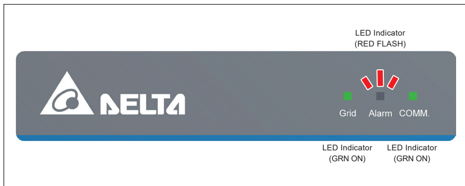
圖 5-5 : SPD故障時的面板顯示
