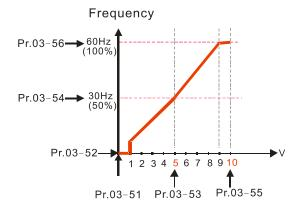
Pr.03-51=0V; Pr.03-52=10% Pr.03-53=5V; Pr.03-54=50% Pr.03-55=10V; Pr.03-56=100%
