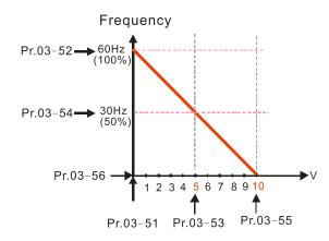
Pr.03-51=1V; Pr.03-52=10% Pr.03-53=5V; Pr.03-54=50% Pr.03-55=10V; Pr.03-56=100%
