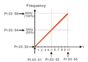
Pr.03-51=0V; Pr.03-52=100% Pr.03-53=5V; Pr.03-54=50% Pr.03-55=10V; Pr.03-56=0%
