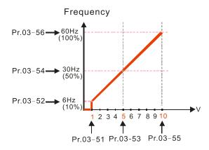
Pr.03-51=1V; Pr.03-52=10% Pr.03-53=5V; Pr.03-54=50% Pr.03-55=9V; Pr.03-56=100%
