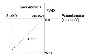
Default: Pr.01.00=60 Hz Pr.04.00=100 % Pr.04.01=1 Pr.04.02=100 % Pr.04.03=1
