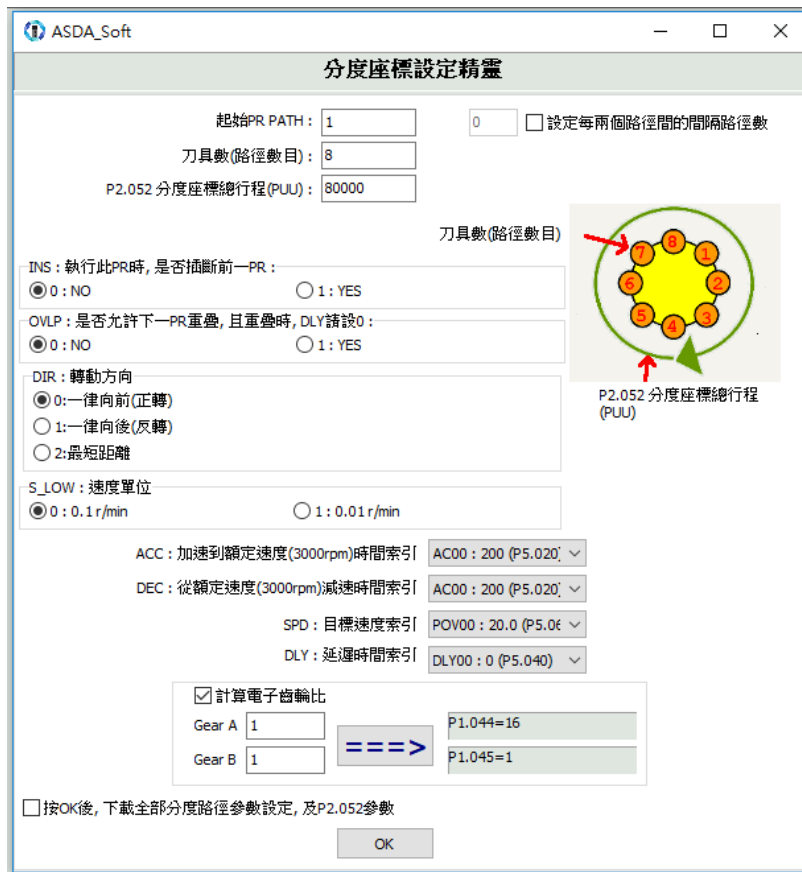
圖 7.1.3.6.2 PR 模式分度座標設定精靈使用者介面
