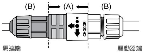
IP67 接頭配線安裝完成後，進行馬達與驅動器兩端接頭安裝時，只能抓取(A)處進行對鎖，禁止拉拔或旋轉(B)夾環與螺紋密封螺母，以免造成接頭連接處鬆動，進而無法符合 IP67 防護等級之架構。
