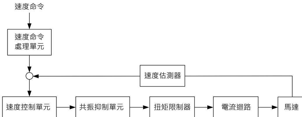
其中，速度命令處理單元是根據 6.3.1 節的敘述來選擇速度命令來源，包含比例器 (P1.040) 設定類比電壓所代表的命令大小以及 S 形命令平滑器設定速度命令的平滑化。速度控制單元管理驅動器的增益參數，即時運算供給馬達的電流命令。共振抑制單元抑制機械結構發生共振現象。
