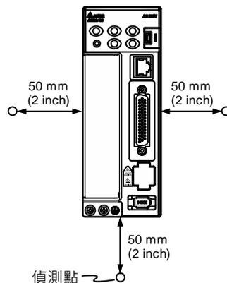
本產品驅動器使用環境溫度為  $0^{\circ}\text{C}$  ~  $55^{\circ}\text{C}$ 。若環境溫度超過  $45^{\circ}\text{C}$  以上，請置於通風良好之場所。若需長時間的運轉，建議在  $45^{\circ}\text{C}$  以下的環境溫度，以確保產品性能。本產品需以垂直方向裝在配電箱裡（如 2.3 節的正確方向圖），且於配電箱上方安裝風扇，使運轉產生的熱風順利從箱內排出，並確保驅動器兩側及下方距離機身 5 公分處溫度不可超過  $55^{\circ}\text{C}$ ，遠離熱源，亦即配電箱的大小及通風條件必須防止內部使用的電子裝置過熱。另外，請注意機器的震動是否會影響配電箱的電子裝置。
