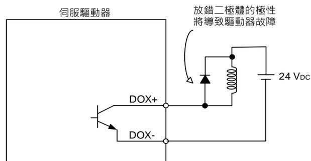
DI 接線以繼電器或開集極電晶體輸入信號。
