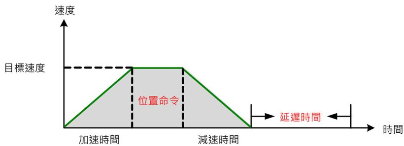
圖 7.1.3.3.2 PR 模式定位控制各參數示意圖
