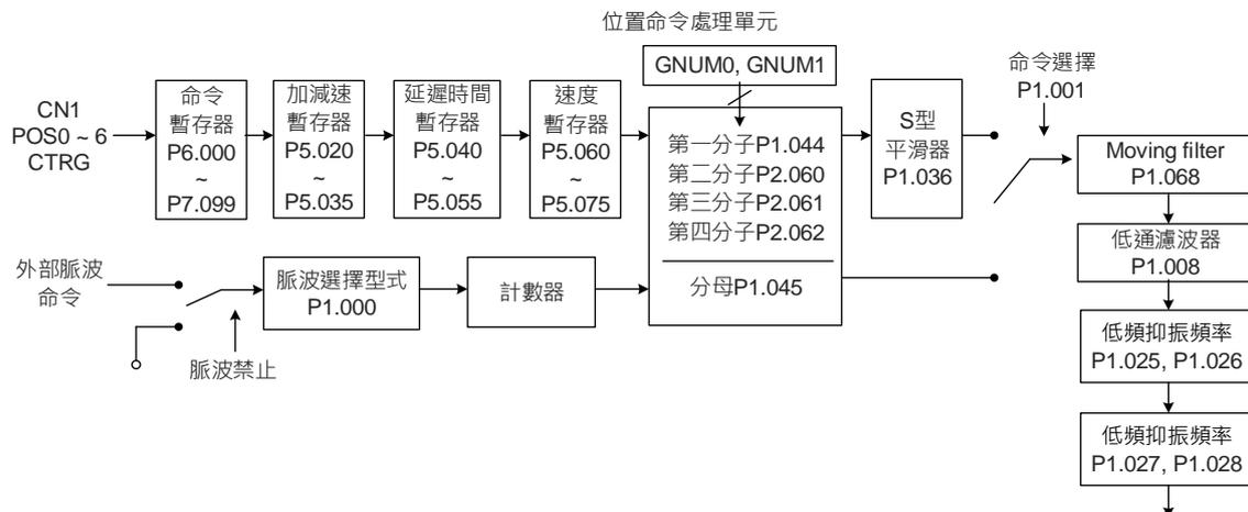
圖中上方路徑是 PR 模式，下方是 PT 模式，可利用 P1.001 來選擇。兩種模式均可設定電子齒輪比，以便設定適合的定位解析度，也可以利用 Moving Filter 或低通濾波器將指令平滑化，請見如下說明。
