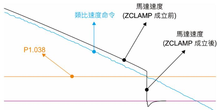
Bit 10 設為 0·命令來源為內部暫存器時·ZCLAMP 功能以經加減速處理的暫存器速度命令·判斷是否作零速箝制·且馬達位置會鎖定於信號發生之瞬間位置。
