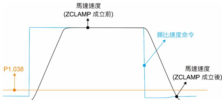
Bit 10 設為 1，命令來源為內部暫存器時，ZCLAMP 功能以經加減速處理的暫存器速度命令，判斷是否作零速箝制，當零速箝制成立時，馬達速度直接設為 0 rpm。
