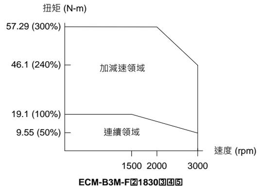
註：伺服馬達型號中之②為編碼器型式、③為煞車或鍵槽 / 油封型式、④為軸徑規格與接頭型式、⑤為特別碼。
