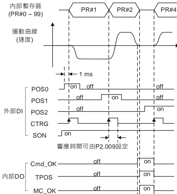
註：Cmd\_OK：PR 命令完成後為 On；TPOS：位置誤差小於 P1.054 設定時為 On；MC\_OK：Cmd\_OK 與 TPOS 輸出時為 On。
