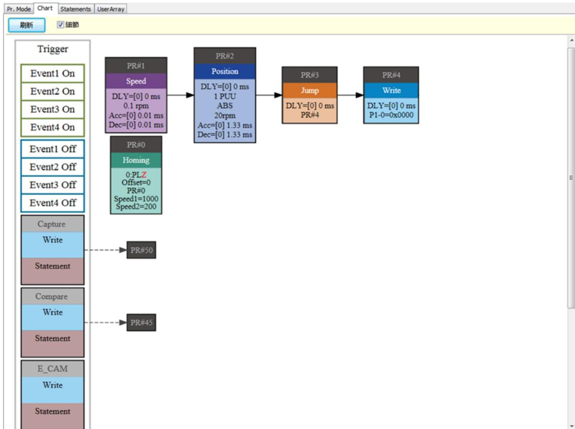
圖 7.1.3 ASDA-Soft PR 圖形化程序介面
