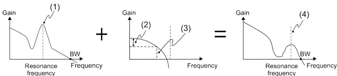
(1) 共振點；(2) 衰減率 (-3 dB)；(3) 低通濾波器 (低通濾波截止頻率 =  $1000 / P2.025$  Hz)；
