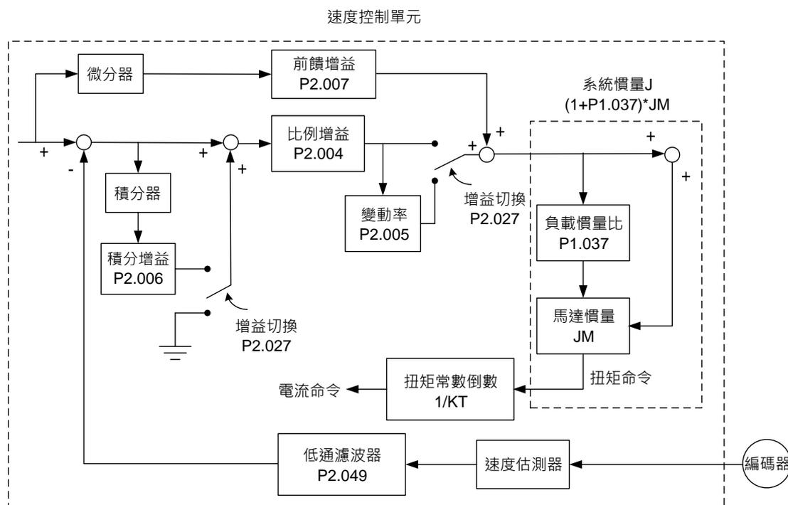
速度控制單元之中有許多的增益 (Gain) 可以調整，而調整的方式有手動模式與兩種增益調整可供使用者來選擇。
