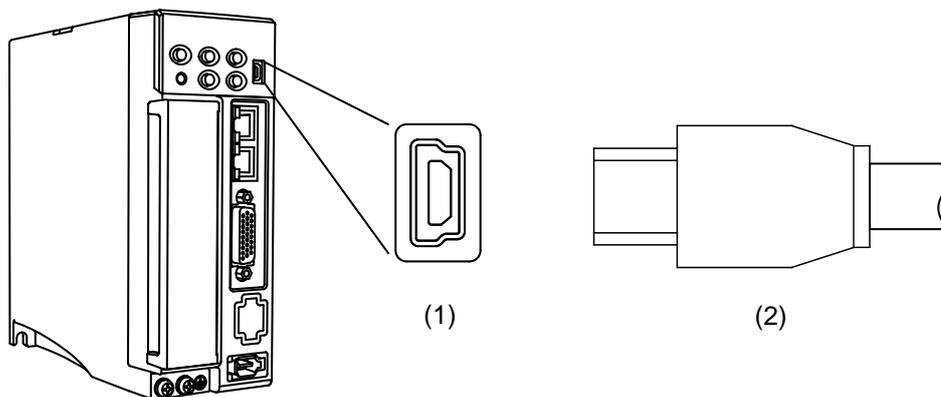
(1) USB 端子座圖；(2) USB 線端接頭
