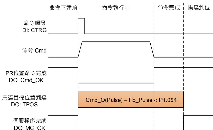
圖 7.1.2.3 PR 模式 DI / DO 訊號示意圖
