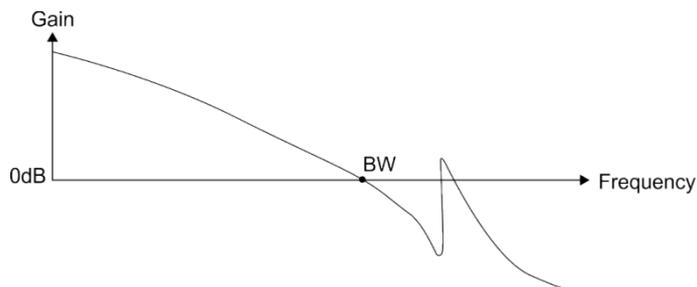
如果可以知道共振頻率，那麼帶拒濾波器可以直接將共振量消除。帶拒濾波器的頻率設定範圍為 50 ~ 5000 Hz，其抑制強度在 0 ~ 40 dB 之間。如果共振頻率不符合此條件，建議使用者利用低通濾波器來降低共振強度。
