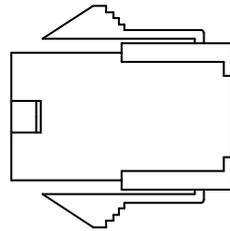
台達型號：ACS3-CNPW1A00 (F80(含)以下機種適用 · IP67 防水接頭)
