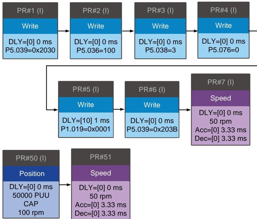
圖 7.2.2.3 高速位置抓取應用範例 PR 程序圖
