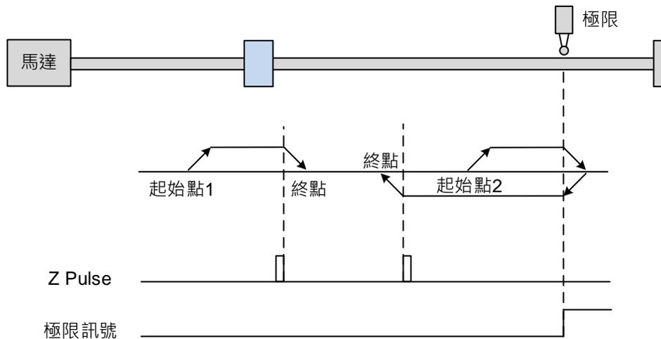
4. 參考原點檢測器下緣訊號：此原點復歸模式是以原點檢測器訊號的下緣為原點參考點。當原點檢測器偵測到訊號後，也可設定是否要參考 Z 脈波來做為原點參考點。
