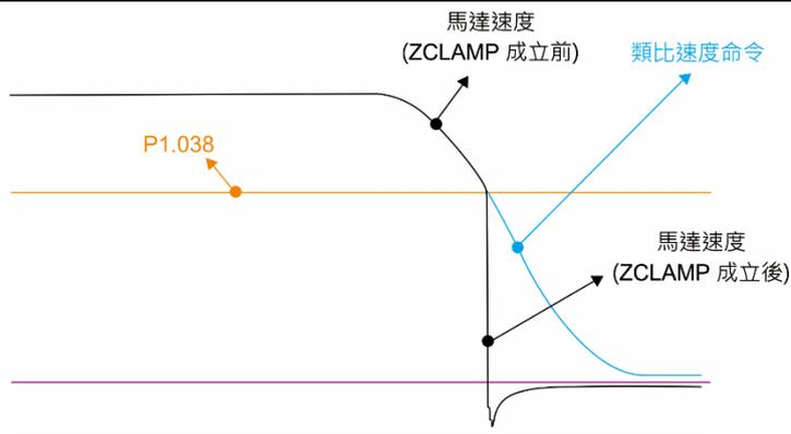
Bit 10 設為 1，命令來源為類比時，ZCLAMP 功能以未經加減速處理的類比速度命令，判斷是否作零速箝制，當零速箝制成立時，馬達速度經過 S 曲線後降至 0 rpm。當零速箝制不成立後，又經由 S 曲線追隨類比速度命令。
