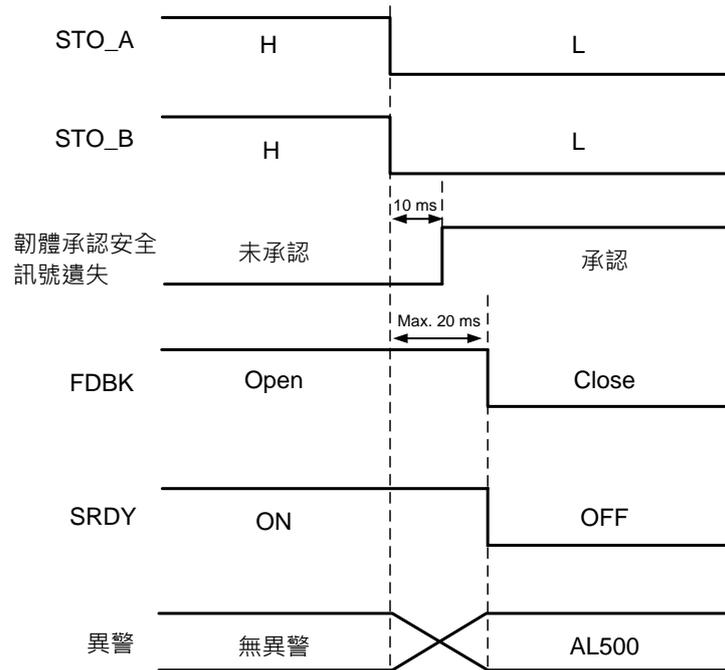
**AL501 / AL502**：如下圖所示，馬達在正常運轉狀態下，當其中一個安全訊號源遺失達 1 s 時，“韌體承認安全訊號遺失”使得伺服驅動器進入 Servo Off 狀態並顯示 AL501 或 AL502 異警，下圖為 AL501 範例。
