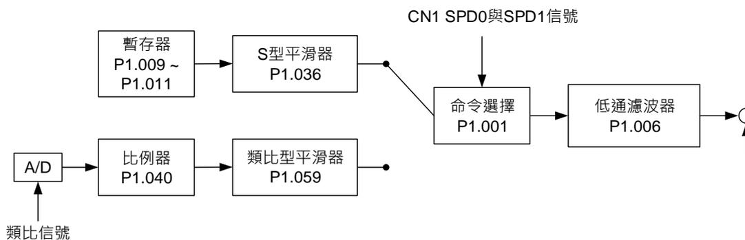
圖中上方路徑為內部暫存器命令，下方路徑為外部類比命令，根據 SPD0 與 SPD1 的狀態以及 P1.001 (S 或 Sz) 來選擇。通常為了對命令信號仍有較平順的響應，此時會需要用到命令平滑器 S 曲線及低通濾波器。
