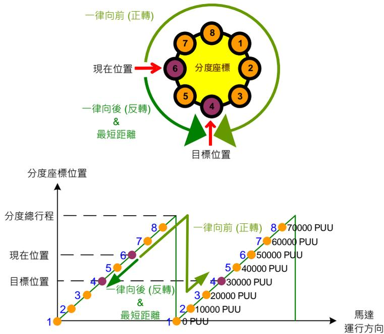
圖 7.1.3.6.4 PR 模式分度座標運轉方向示意圖
