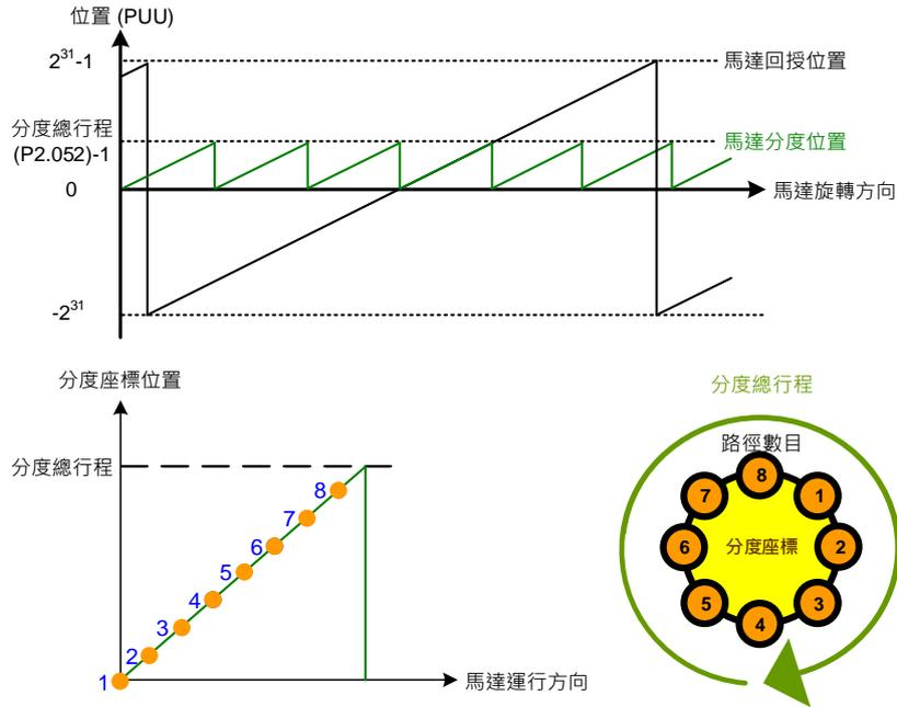
圖 7.1.3.6.1 PR 模式分度座標示意圖
