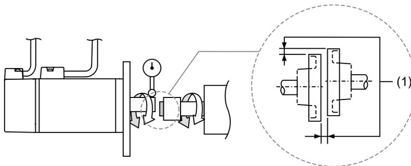
(1) 對心精度在圓周上的四個不同位置測量該距離。最大和最小測量值之間的差值必須為 0.03 mm 或更小，甚至在這樣的範圍內進行調整，以盡可能地提高對心精度。
