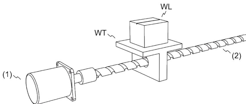
(1) 馬達；(2) 導螺桿的螺距：3 mm (等於 3000 μm)；WL：工件；WT：載台
