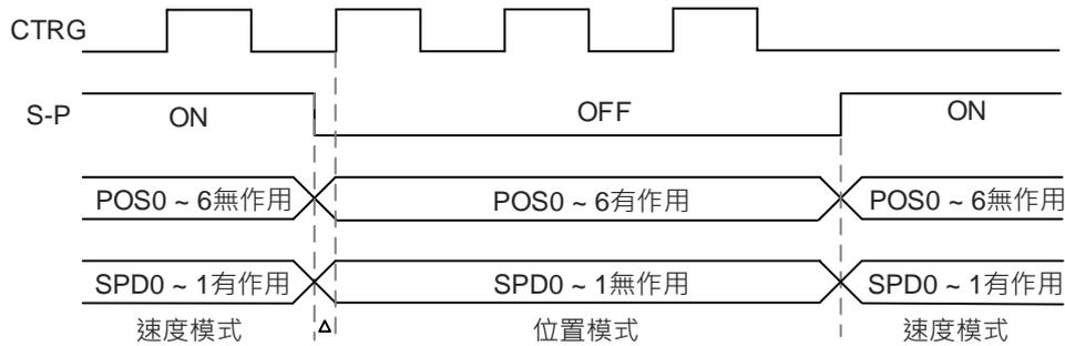
在速度模式時 (DI.S-P 為 ON)，速度命令由 DI.SPD0、DI.SPD1 來選擇，此時 DI.CTRG 無作用。當切換成位置模式之後 (DI.S-P 為 OFF)，由於位置命令沒有定義 (需等待 DI.CTRG 的上升緣)，因此馬達停止 (為上圖中的Δ)。每當 DI.CTRG 的上升緣觸發，將依據 DI.POS0 ~ DI.POS6 來選擇位置命令，馬達立刻往該位置移動，當 DI.S-P 為 ON，則立刻回到速度模式。各模式下 DI 信號與所選擇的命令關係，請參考單一模式的章節介紹。
