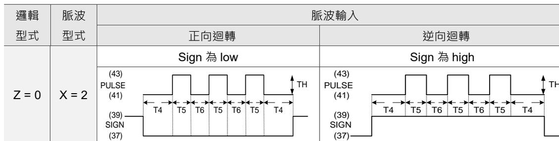
註：通訊型機種的腳位定義與 B3-L 機種不同，SIGN 為 23，/SIGN 為 24，PULSE 為 25，/PULSE 為 26。
