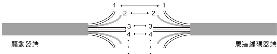
若不使用連接頭 (housing)，請依照芯線編號相對應連接，即 1 對 1、2 對 2...，以此類推。請先將 B3 驅動器端的芯線依照連接頭上的標示依序標上數字，再連接馬達端編碼器引出線。
