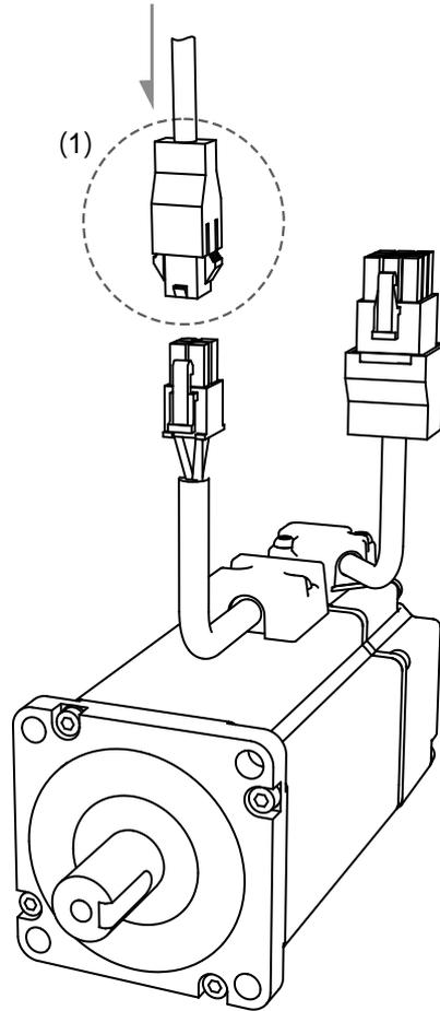
註：B3 與 B2 接腳定義相同，但基於考量使用者配線的便利性，特別修改 B3 連接頭的視入角，故 B3 手冊圖示與 B2 不同。
