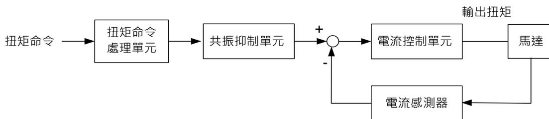
其中，扭矩命令處理單元是根據 6.4.1 節來選擇扭矩命令的來源，包含比例器 (P1.041) 設定類比電壓所代表的命令大小，以及處理扭矩命令的平滑化。電流控制單元管理驅動器的增益參數，並負責即時運算供給馬達的電流大小，目前只提供命令端設定。
