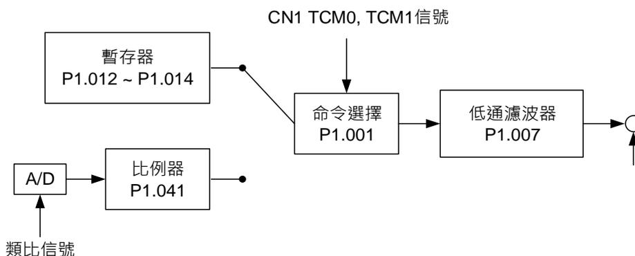
圖中上方路徑為內部暫存器命令，下方路徑為外部類比命令，根據 TCM0 及 TCM1 的狀態以及 P1.001 (T 或 Tz) 來選擇。類比電壓命令代表的扭矩大小可用比例器調整，並採用低通濾波器以便對命令信號達到較平順的響應。
