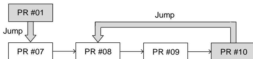
圖 7.1.3.4.1 PR 模式程序跳躍命令示意圖
