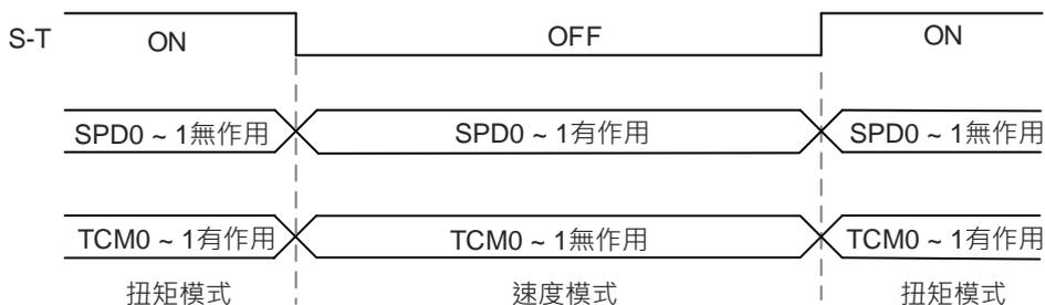
在扭矩模式時 (DI.S-T 為 On)，扭矩命令由 DI.TCM0、DI.TCM1 來選擇。當切換成速度模式之後 (DI.S-T 為 Off)，速度命令由 DI.SPD0、DI.SPD1 來選擇，馬達立刻追隨命令轉速旋轉，當 S-T 為 On，則立刻回到扭矩模式。各模式下 DI 信號與所選擇的命令關係，請參考單一模式的章節介紹。
