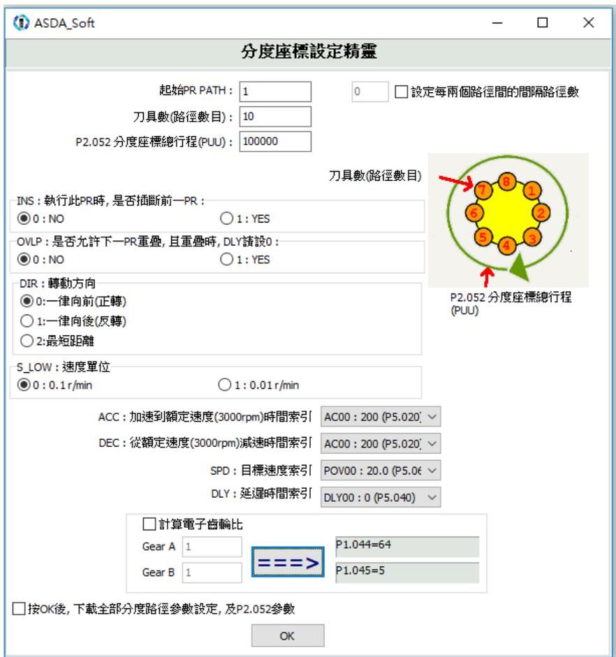
圖 7.1.3.6.2 PR 模式分度座標設定精靈使用者介面
