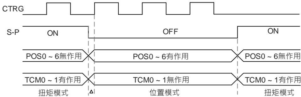
在扭矩模式時 (DI.T-P 為 On)，扭矩命令由 DI.TCM0、DI.TCM1 來選擇，此時 DI.CTRG 無作用。當切換成位置模式之後 (DI.T-P 為 Off)，由於位置命令沒有定義 (需等待 DI.CTRG 的上升緣)，因此馬達停止 (為上圖中的Δ)。每當 DI.CTRG 的上升緣觸發，將依據 DI.POS0 ~ DI.POS6 來選擇位置命令，馬達立刻往該位置移動，當 DI.T-P 為 On，又立刻回到扭矩模式。各模式下 DI 信號與所選擇的命令關係，請參考單一模式的章節介紹。
