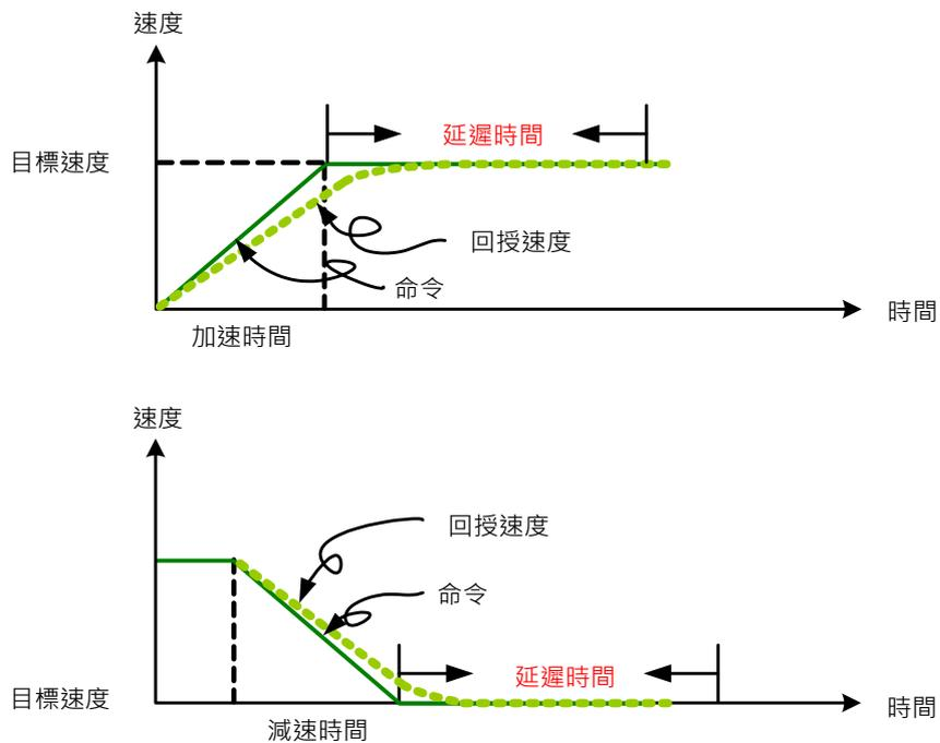
圖 7.1.3.2.2 PR 模式定速控制各參數示意圖
