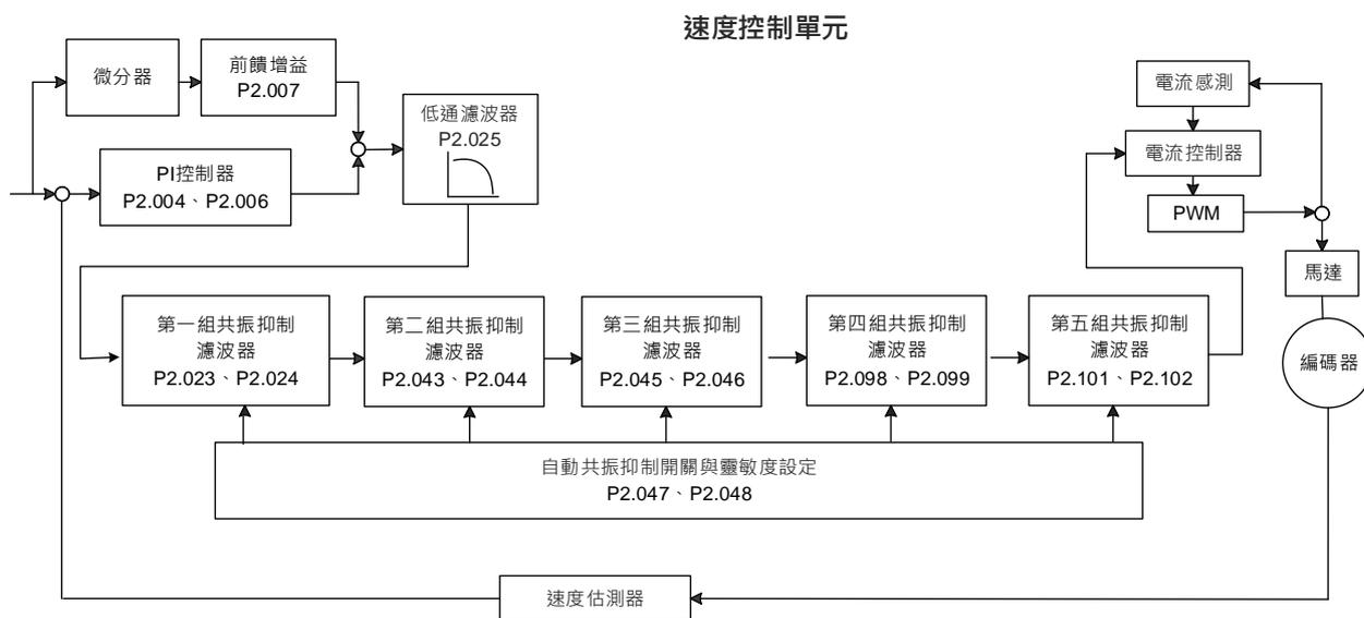
B3 提供兩種共振抑制的方式：帶拒濾波器 (Notch Filter) 及低通濾波器。以下圖示說明其效果。
