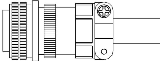
台達型號：ACS3-CNPW6300 (F100 ~ F180 煞車機種適用，軍規接頭：CMV1-2S)
