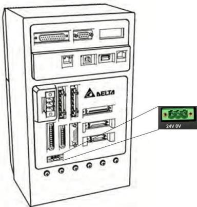
圖 5-7 控制器端主迴路電源接頭座
