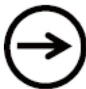
圖 4-3 緊急停止安全斷開符號
