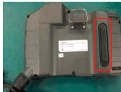
圖 5-50 手持式教導器 Enable switch 圖示
