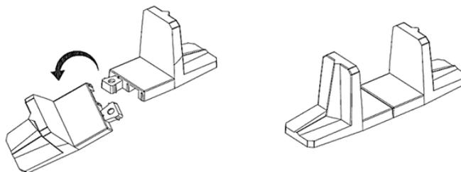
圖6-9：組裝塔式固定架
