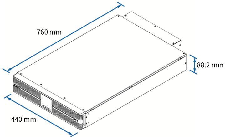
圖2-1：RT-15K3P/ RT-20K3P 外觀 & 尺寸
