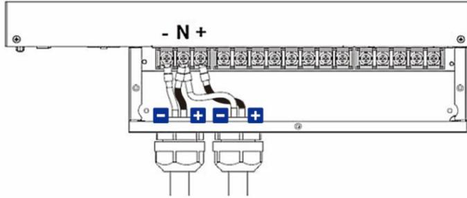
圖8-2：UPS出貨前已安裝的電池線和電纜線接頭
