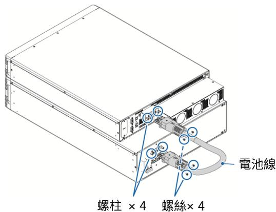
图8-1：连接RT-10K3P UPS和台达铅酸电池箱
