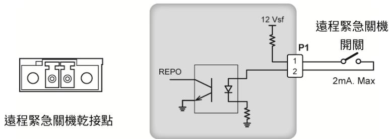
圖5-2：遠程緊急關機乾接點與腳位圖
