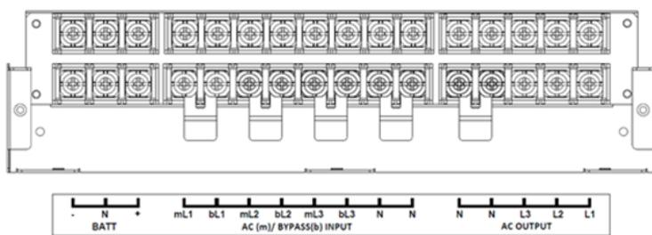
圖7-16：銅排安裝方式\_單迴路三相輸入 & 三相輸出
