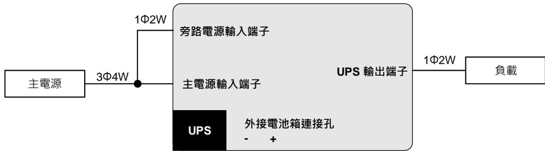
圖7-5：UPS配線圖\_單迴路三相輸入 & 單相輸出
