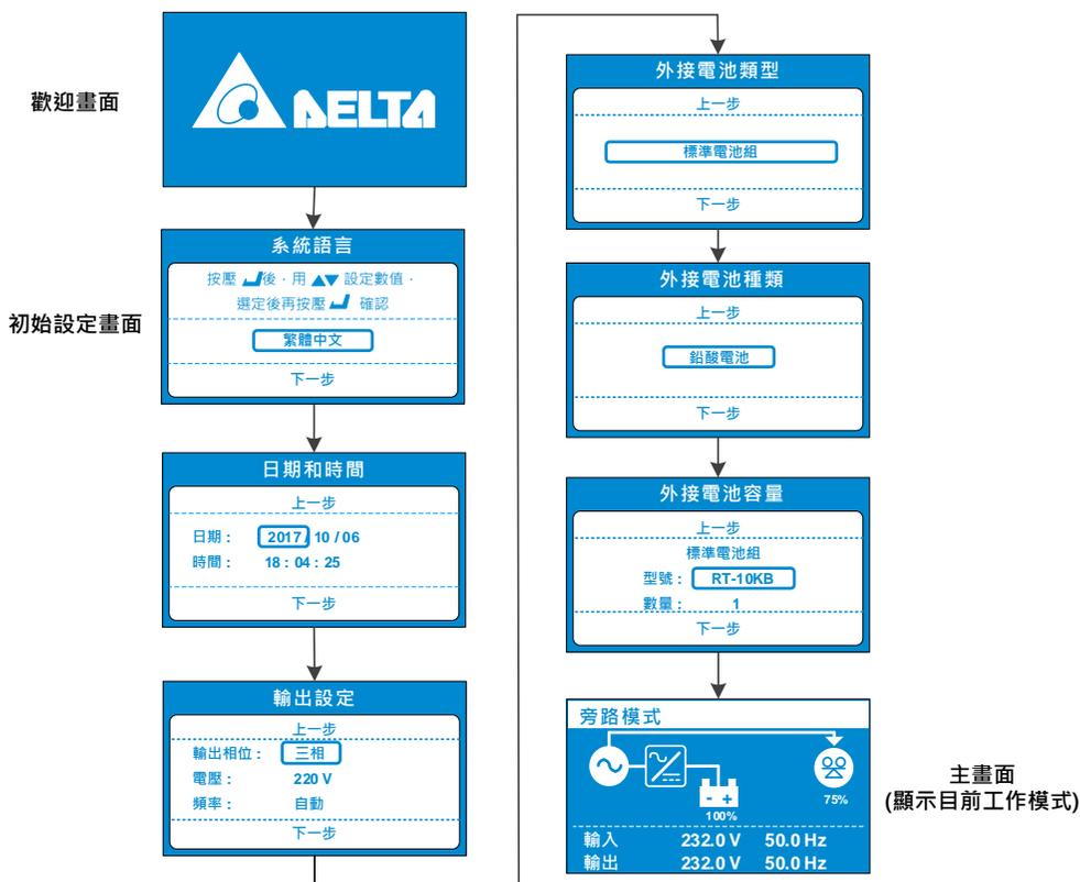
完成以上設定後，將不再顯示初始設定畫面。下次開機時，畫面顯示DELTA歡迎畫面3秒後，將直接進入主畫面 (顯示目前的工作模式)，如下圖。
