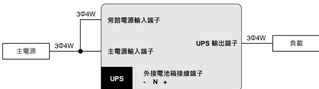
圖7-17：UPS配線圖\_單迴路三相輸入 & 三相輸出
