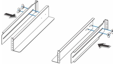
圖6-2：調整固定導軌並鎖緊螺帽
