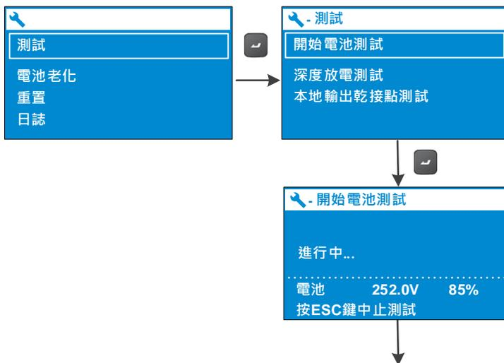
測試完成後，測試結果如下所示。
