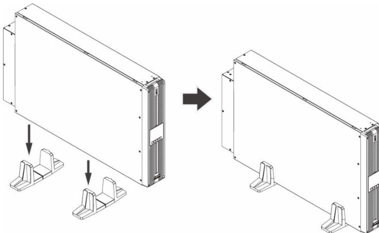
圖6-11：將UPS放入塔式固定架底座
