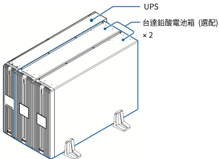
圖6-12：塔式安裝\_1台UPS與2台台達鉛酸電池箱
