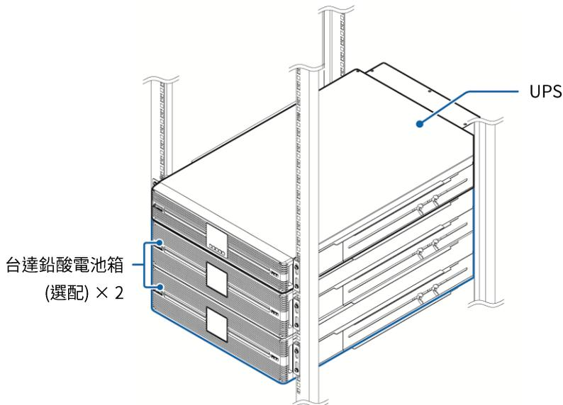
圖6-5：機架式安裝\_1台UPS與2台台達鉛酸電池箱
