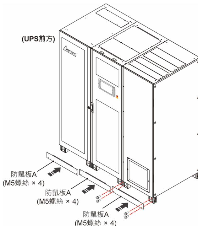
(圖 5-27：在 800kVA UPS 前方底端安裝防鼠板 A)
