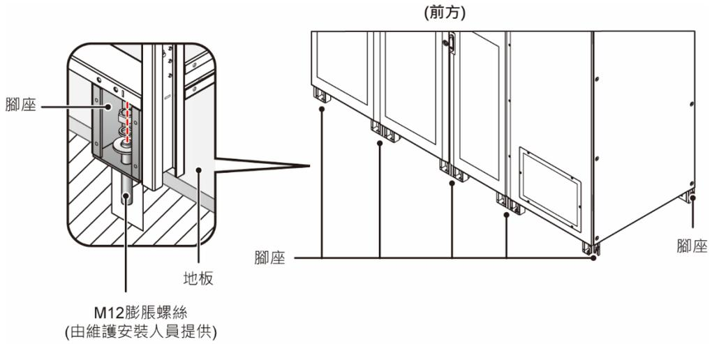
(圖 5-7 : 1000/ 1200kVA UPS\_ 將腳座鎖附於地板)
