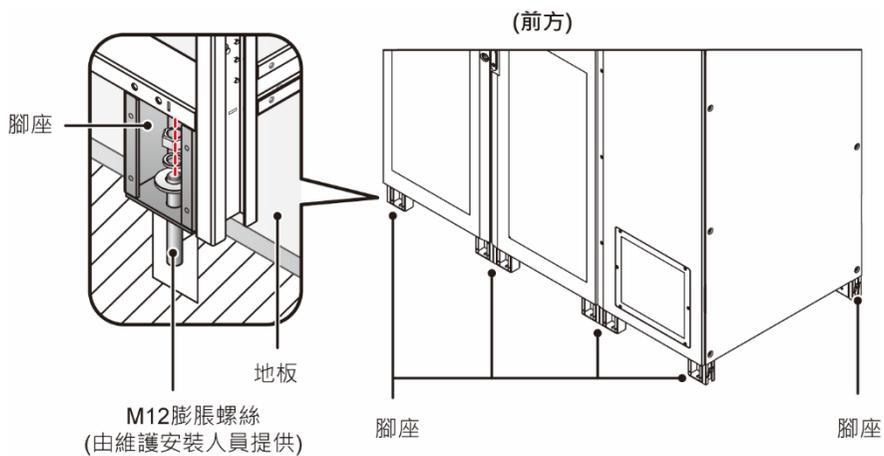
(圖 5-6 : 800kVA UPS\_ 將腳座鎖附於地板)
