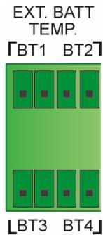
(圖 4-5 : 外接電池溫度偵測口 (EXT. BATT TEMP.) 腳位圖)
