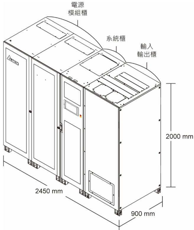
(圖 2-2 : 1000/ 1200kVA UPS 外觀 & 尺寸)
