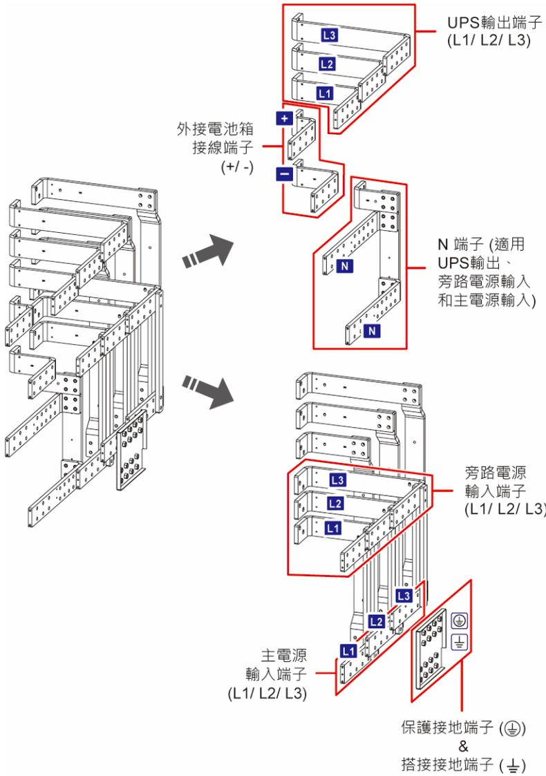
(圖 2-10 : 800kVA UPS\_ 位於輸入輸出櫃內部的配線端子)
