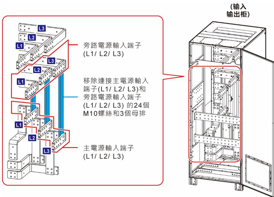
(圖 5-11 : 1000/ 1200kVA UPS\_ 移除連接主電源輸入端子 (L1 /L2 /L3) 和旁路電源輸入端子 (L1/ L2/ L3) 的 24 個 M10 螺絲和 3 個母排)
