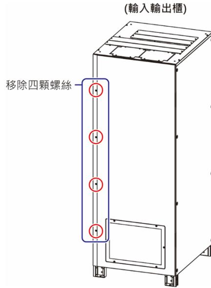
(圖 2-7 : 1000/ 1200kVA UPS\_ 輸入輸出櫃前門打開方式)
