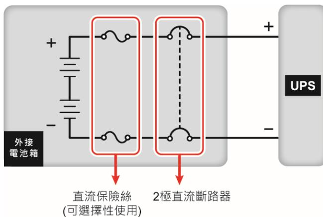
(圖 5-25 : 安裝 2 極直流斷路器 (選擇性串接直流保險絲))
