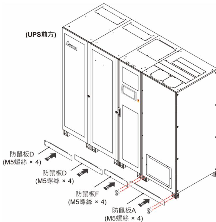
(圖 5-30 : 在 1000/ 1200kVA UPS 前方底端安裝防鼠板 A、D & F)
