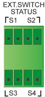
(圖 4-6：外接開關/ 斷路器狀態偵測乾接點 (EXT. SWITCH STATUS) 腳位圖)
