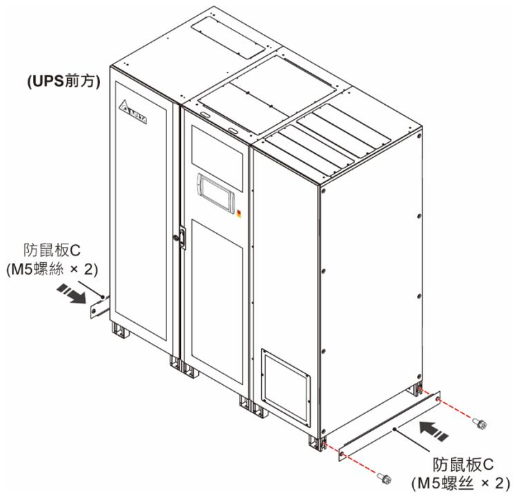
(圖 5-29 : 在 800kVA UPS 兩側底端安裝防鼠板 C)
