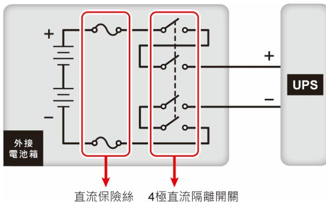
(圖 5-22：安裝 4 極直流隔離開關串接直流保險絲)
