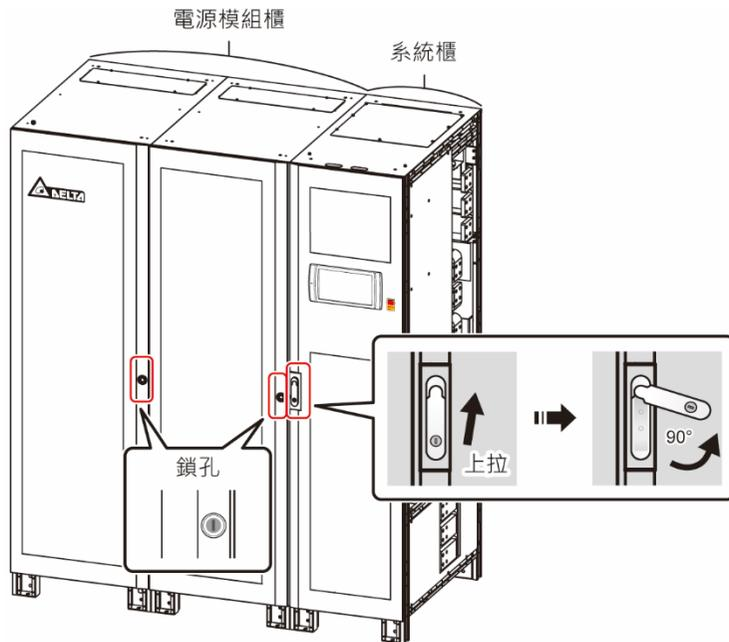
(圖 2-8 : 1000/ 1200kVA UPS\_ 電源模組櫃 & 系統櫃前門打開方式)
