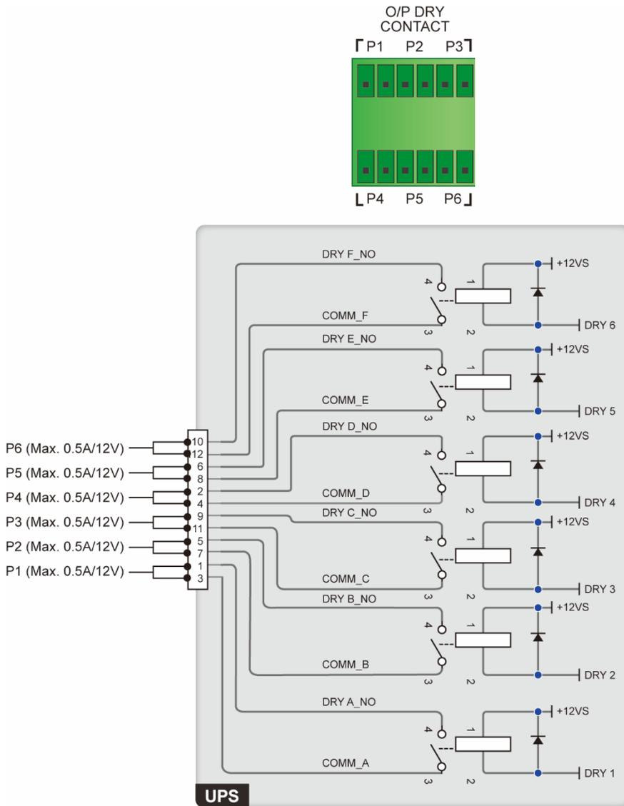
(圖 4-7：輸出乾接點 (O/P DRY CONTACT) 腳位圖)
