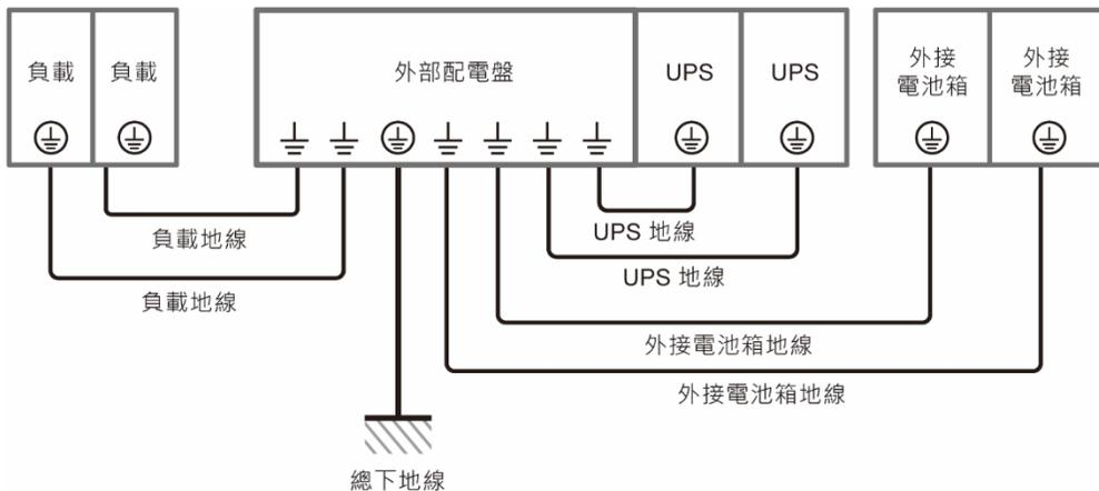
(圖 5-20：接地配線圖\_ 並機)
