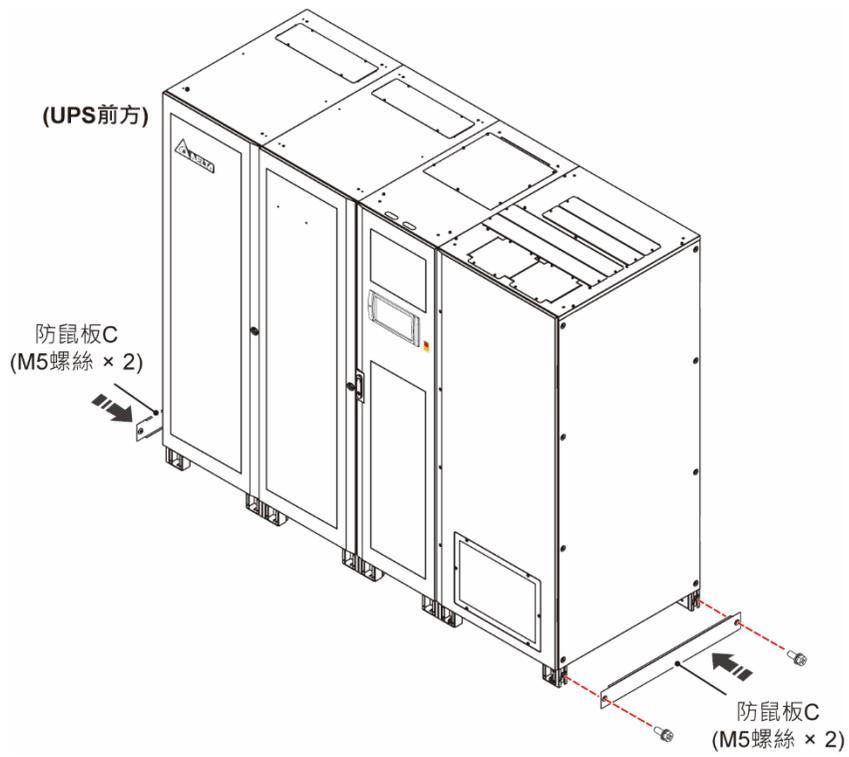
(圖 5-32 : 在 1000/ 1200kVA UPS 兩側底端安裝防鼠板 C)
