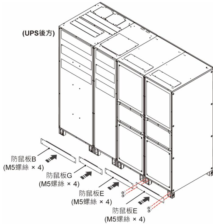
(圖 5-31 : 在 1000/ 1200kVA UPS 後方底端安裝防鼠板 B、E & G)
