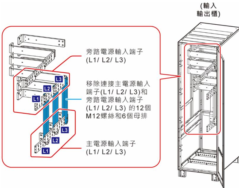
(圖 5-10 : 800kVA UPS\_ 移除連接主電源輸入端子 (L1 /L2 /L3) 和旁路電源輸入端子 (L1/ L2/ L3) 的 12 個 M12 螺絲和 6 個母排)
