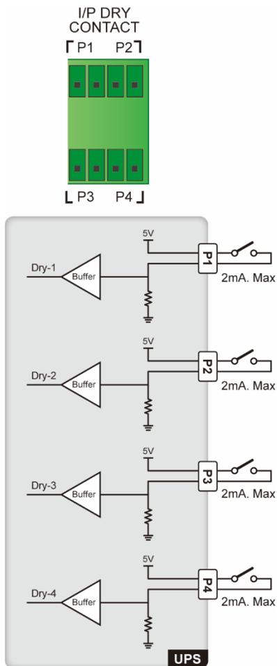
(圖 4-8：輸入乾接點 (I/P DRY CONTACT) 腳位圖)
