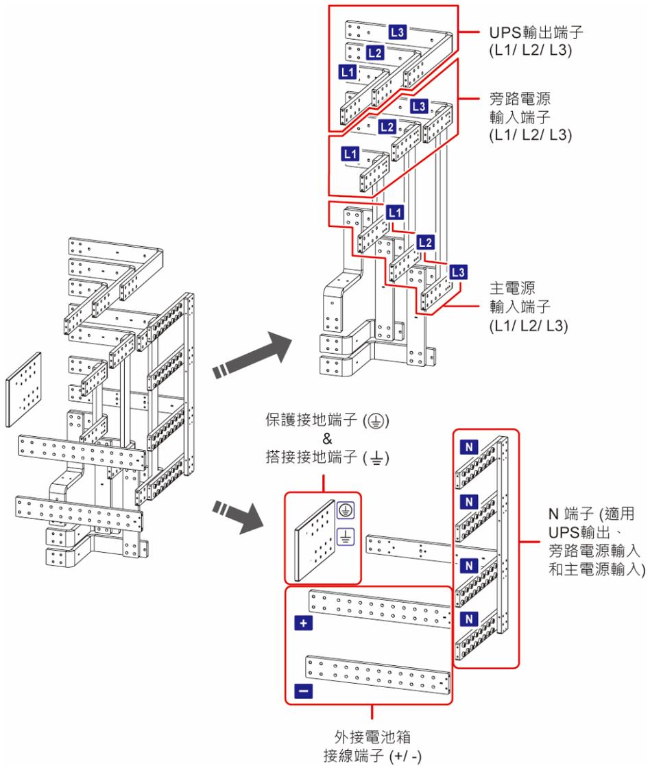
(圖 2-14 : 1000/ 1200kVA UPS\_ 位於輸入輸出櫃內部的配線端子)
