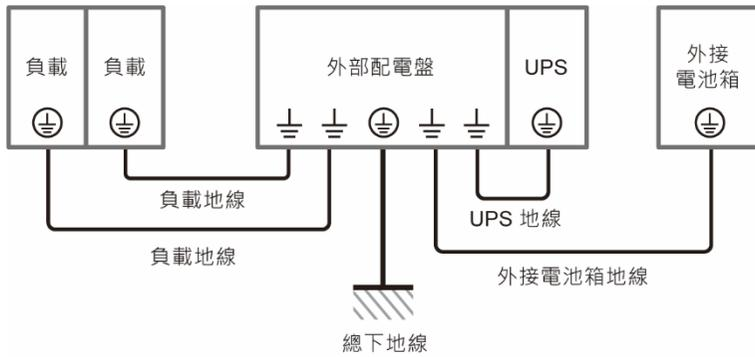
(圖 5-17：接地配線圖\_單機)
