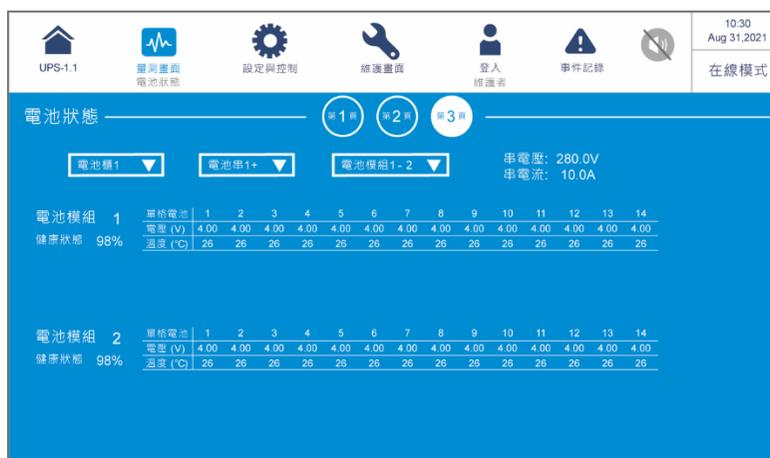
進入此畫面後，可利用左上方的三個選單選擇欲查詢的電池櫃、電池串以及電池模組，來查看電池串的串電壓和串電流、電池模組的健康狀態，以及單體電池的電壓及溫度讀值。
