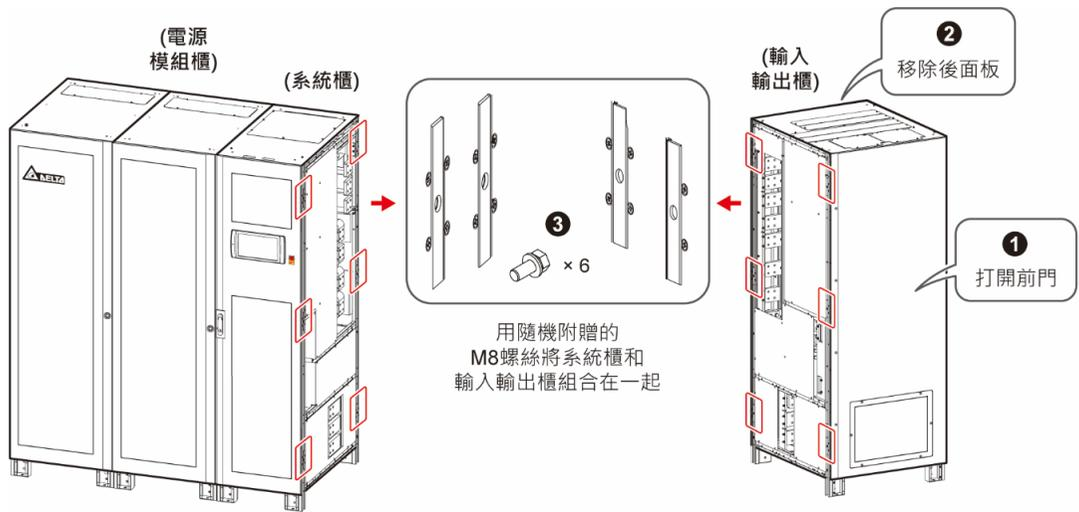
(圖 5-3 : 1000/ 1200kVA UPS\_ 將系統櫃和輸入輸出櫃組合在一起)
