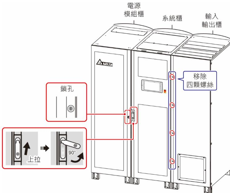
(圖 2-4 : 800kVA UPS\_ 前門打開方式)
