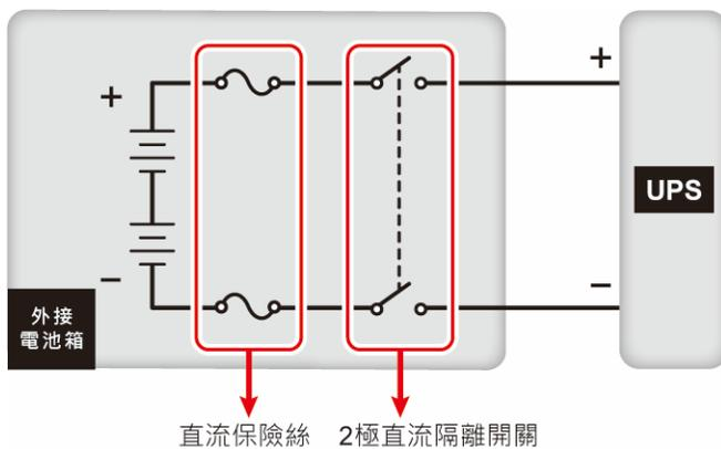
(圖 5-23：安裝 2 極直流隔離開關串接直流保險絲)
