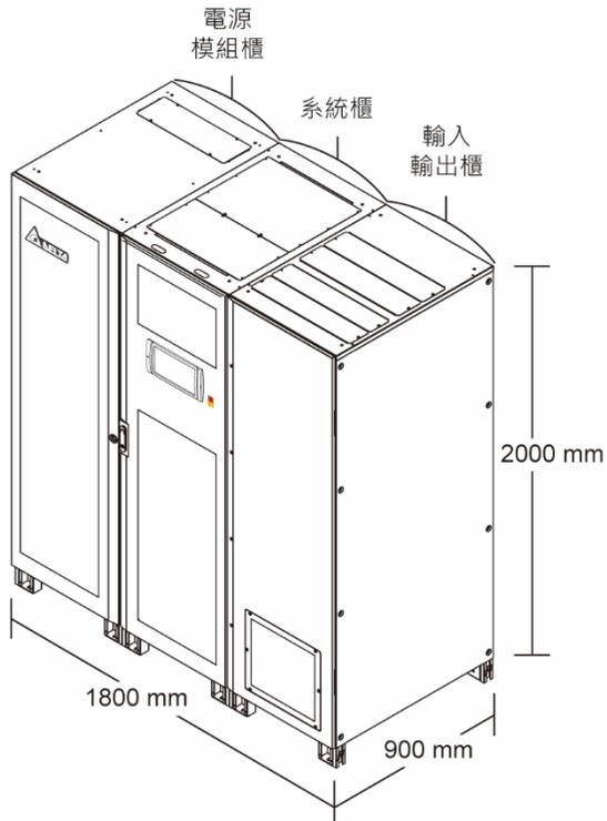
(圖 2-1 : 800kVA UPS 外觀 & 尺寸)
