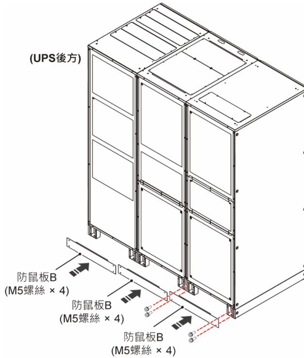
(圖 5-28 : 在 800kVA UPS 後方底端安裝防鼠板 B)
