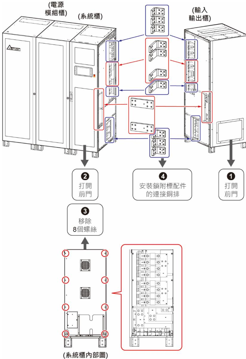
(圖 5-8 : 1000/ 1200kVA UPS\_ 安裝鎖附標配件的連接銅排)
