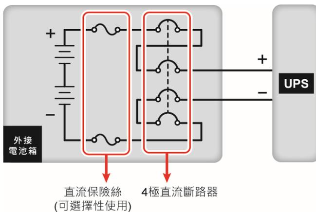
(圖 5-24 : 安裝 4 極直流斷路器 (選擇性串接直流保險絲))
