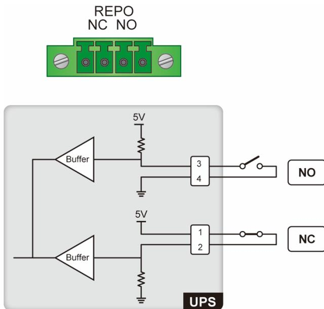
(圖 4-2：遠程緊急關機乾接點 (REPO) 腳位圖)
