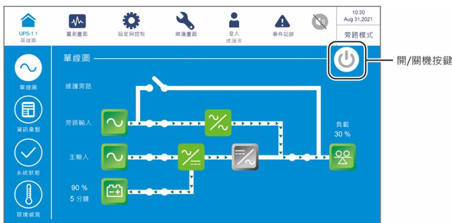
4. 畫面顯示的外接電池箱的斷路器 (Q5) 在預設情況下始終為 **ON**，如欲啟用觸控面板的 Q5 狀態檢測功能，請洽台達客服人員。
