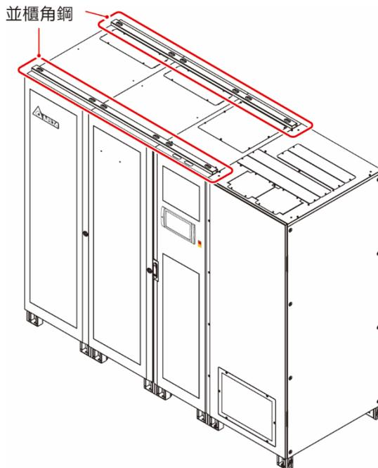
(圖 5-9 : 1000/ 1200kVA UPS\_ 移除並櫃角鋼)
