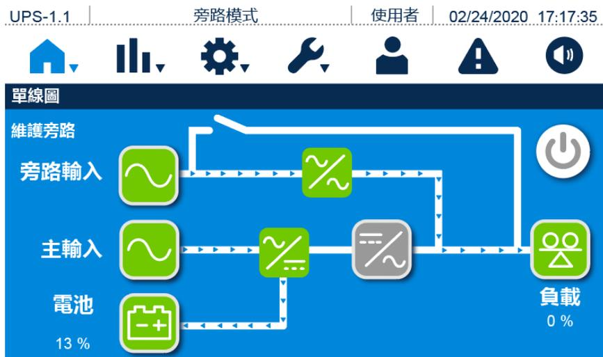
6) 以下畫面表示 UPS 在頻率轉換模式下工作，限制旁路輸出。有關頻率轉換模式設定，請參閱 7.9.2 模式設定 及 6.2.6 頻率轉換模式開機程序。
