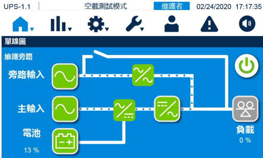
(圖 6-25：空載測試模式畫面)
