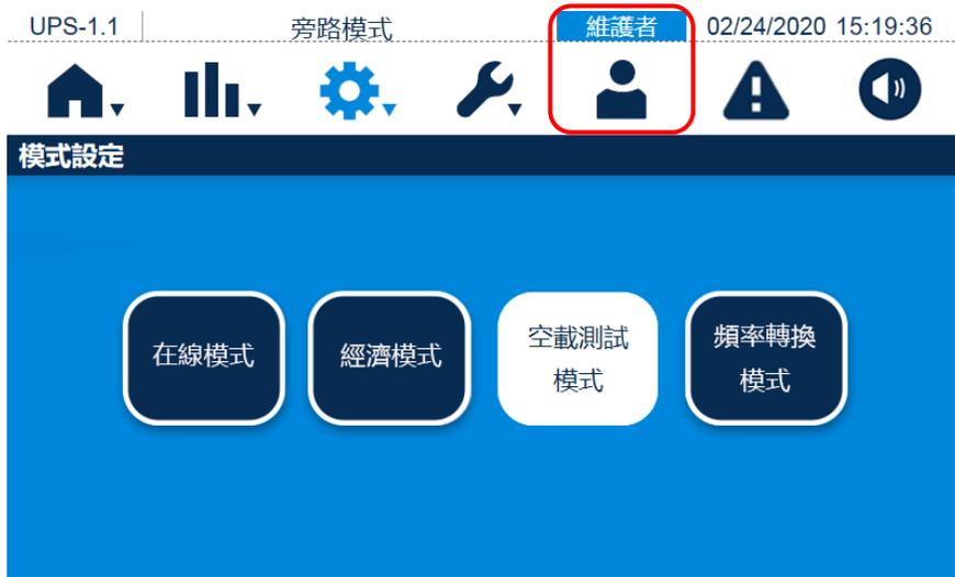
(圖 6-23 : 手動設定空載測試模式)
