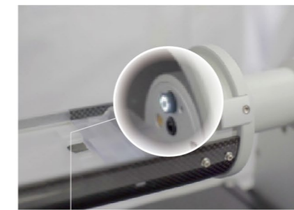
內嵌式LED發光攝影機 即時觀察小動物於造影過程中活動狀態，可由攝影機影像進行即時小動物呼吸訊號偵測，並於介面中顯示呼吸訊號資訊。
