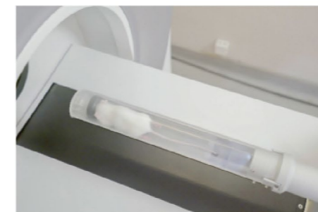
防脫逃上蓋，可避免實驗過程中小動物因麻醉不完全而脫逃。
