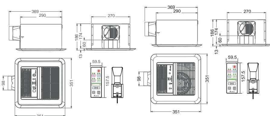
面板尺寸: 351 X 351mm 出风口尺寸: Ø100mm
