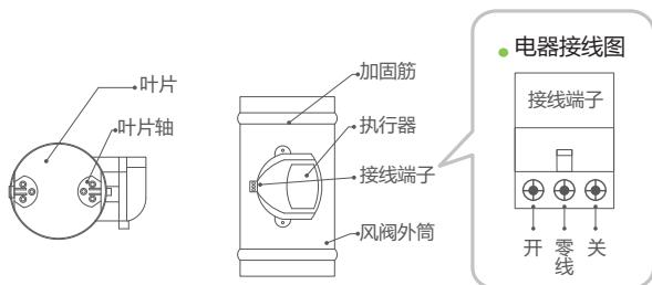
技术参数: 建议采用 0.5 至 0.7mm<sup>2</sup> 多股铜线
