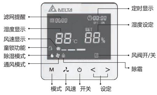
除湿新风机 液晶控制面板
