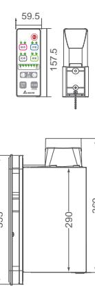
面板尺寸: 360X360mm 出风口尺寸: Ø100mm
