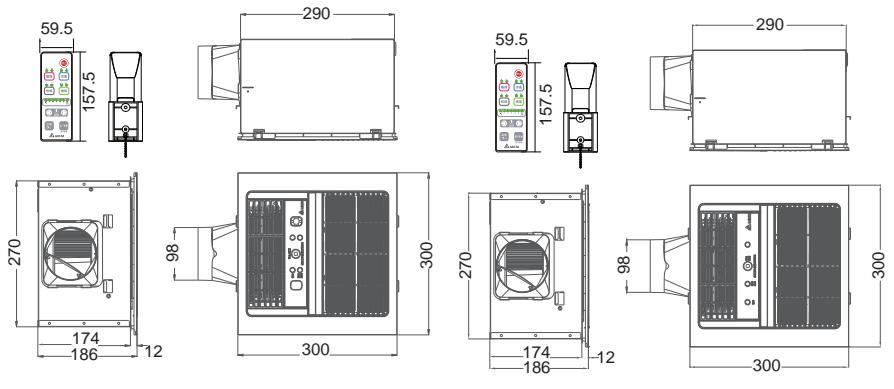
面板尺寸: 300X300mm 出风口尺寸: Ø100mm
