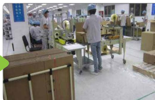
改用自動封箱機，可節省 2 個人力並加速工作流程
