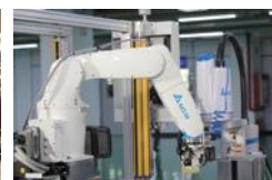
垂直多關節機器人應用於 SCARA 機器人生產線五項功能測試，大幅縮短產品測試時間
