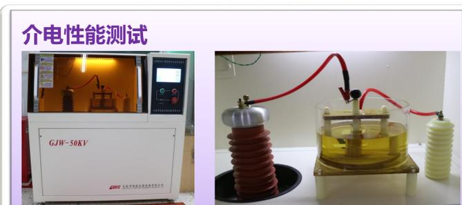
绝缘片、胶材等耐压能力测试
