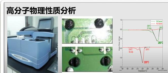
材料熔点、结晶点等鉴定
