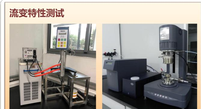
胶材粘度、触变及固化性能分析
