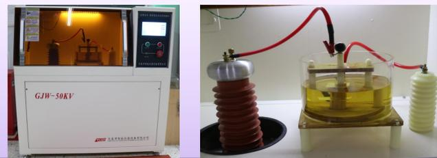
绝缘片、胶材等耐压能力测试
