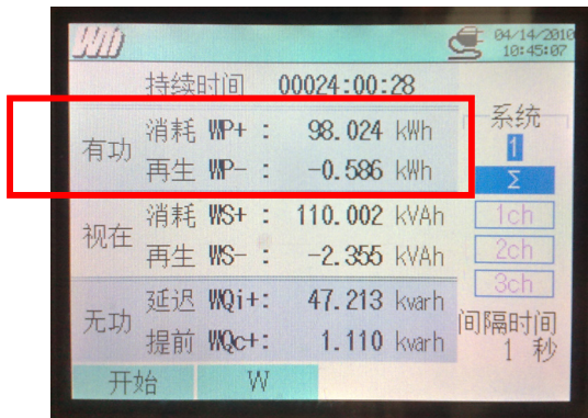
〈圖三〉未使用 AFE2000 時，累積消耗功率 kWh
