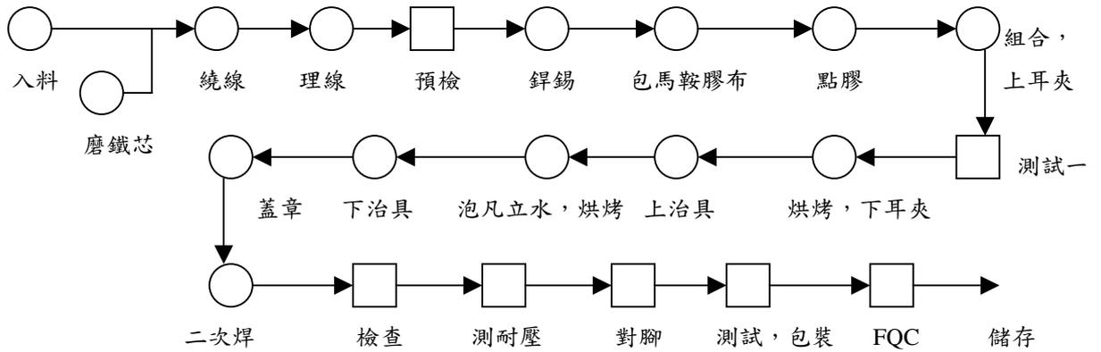
視訊產品製造流程- 顯示器
