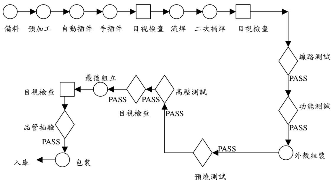
零組件產品製造流程- 電磁零件
