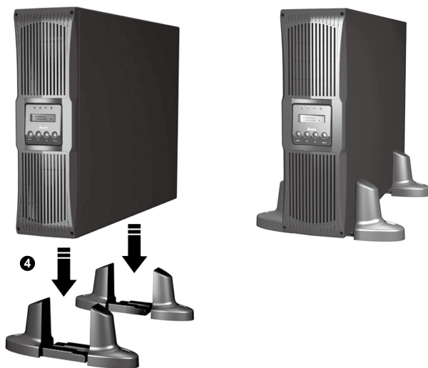
(Figure 4-6 : Installation de l'UPS dans les pieds de la tour)
