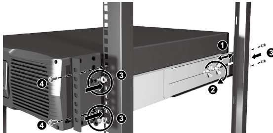
(Figure 4-2 : Montage sur châssis)
