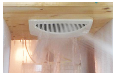
防水等級測試設備 防潮與灑水測試
