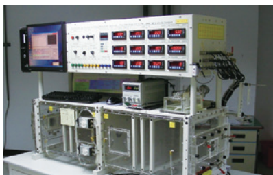
風洞測試設備 風壓風量測試
