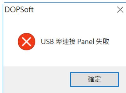
2. 下載時，顯示 ”no response from HMI ” 錯誤訊息，代表此時人機的 USB 的通訊模式選為”DISK”，在 DISK 傳輸模式下，電腦無法對人機寫入資料，造成的原因可能是防毒軟體、公司禁止對外部 USB 裝置寫入資料...等等原因造成。
