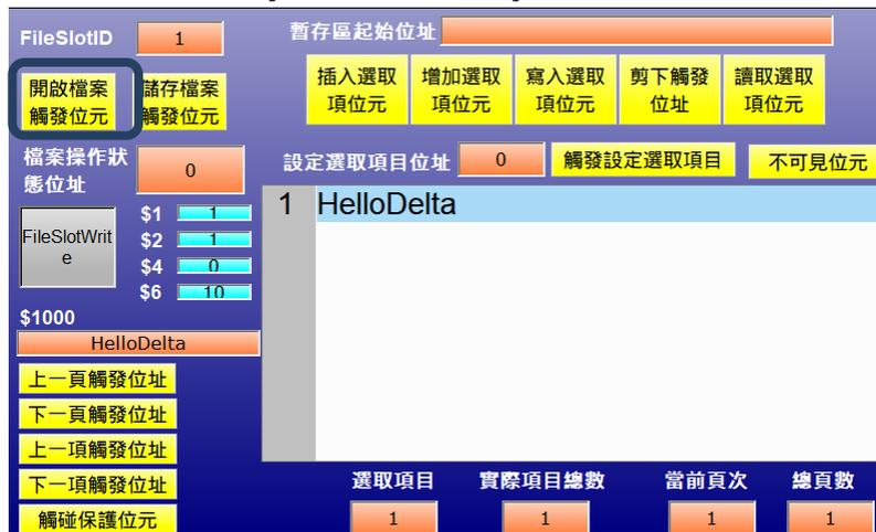
透過文字清單元件開啟 FileSlot 資料，再結合[讀取選取項位元]、[寫入選取項位元]、[剪下觸發位址]、[增加選取項位元]、[插入選取項位元]、[暫存區起始位址]操控文字資料。
