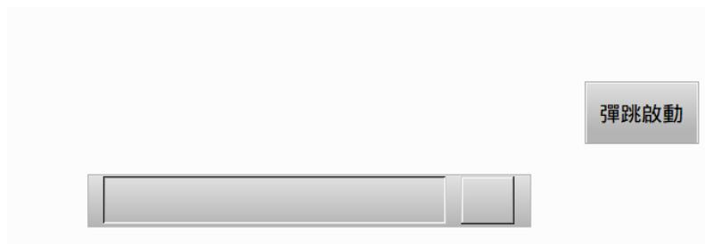
Step2、請先執行彈跳啟動位元後，再點選 Barcode 輸入元件，此時會顯示輸入鍵盤。
