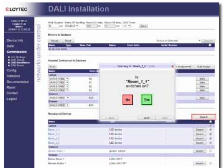
L-DALI Web インターフェースによるDALI調整作業
